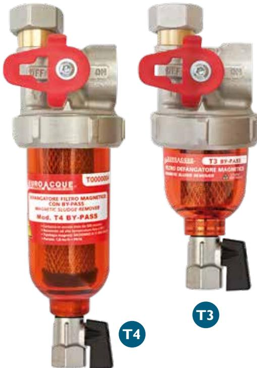
**DESCRIZIONE.** Mini defangatore filtro magnetico con attacco a squadra, codolo superiore e valvola integrata di by pass e chiusura impianto per una installazione facile, rapida e salvaspazio (con il T3 in meno di 5 cm di interasse per una altezza massima di 15 cm hai tutto, defangatore e valvola) sotto le caldaie a condensazione. L'unico defangatore BREVETTATO con valvola integrata a 3 funzioni:
